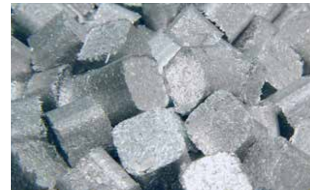
Durch das Pressen der anfallenden Späne, kann die MS XTEC Öl zurückgewinnen, welches dann im Produktionsprozess wiederverwendet werden kann.
